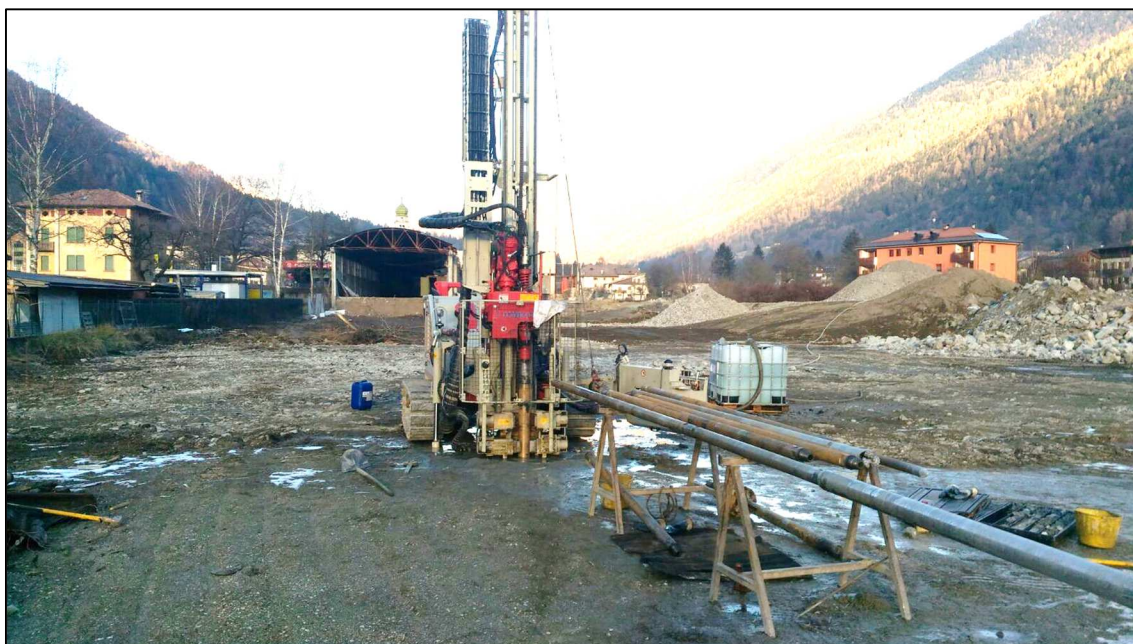
Posizionamento della sonda per l'esecuzione del sondaggio n.1
